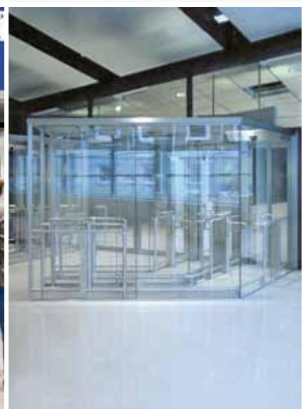
One-way Schleuse in Ganzglasoptik mit abgewinkeltem Grundriss - um den Durchwurf von Gegenständen zu verhindern
